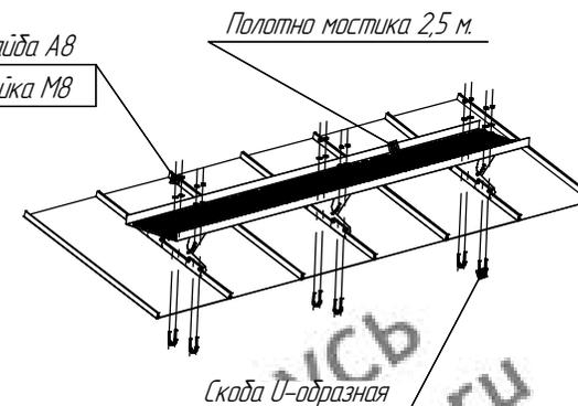
Внимание! Контрольную затяжку крепежа производить с помощью динамометрического ключа. Рекомендуем усилие затяжки 10-15 Нм.
