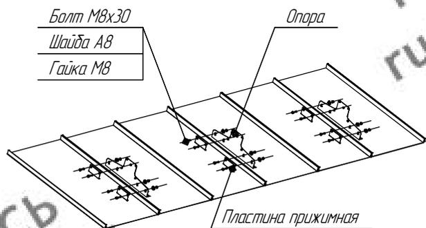
Внимание! Контрольную затяжку крепежа производить с помощью динамометрического ключа. Рекомендуем усилие затяжки 10-15 Нм.
